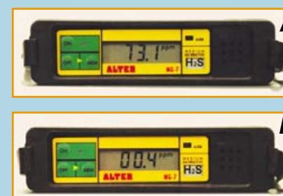
Stężenie siarkowodoru na wlocie (A) i wylocie (B) z urządzenia
