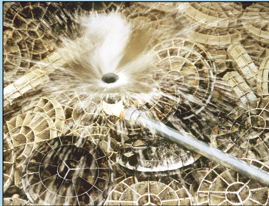
System zraszania nie zawiera części ruchomych
